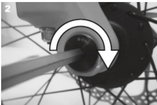
2. Apriete el eje con una llave Allen de 6 mm con el par de apriete sugerido de 8-10 Nm.
