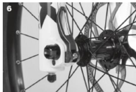
6. La palanca debe quedar a nivel con el cárter inferior.
