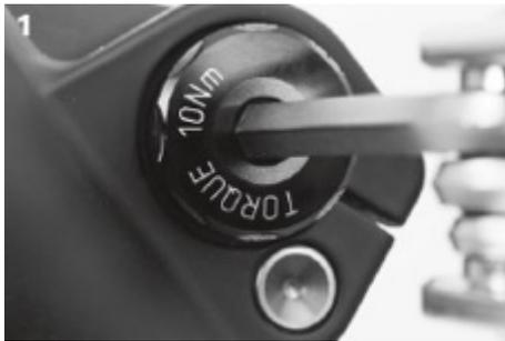
1. Introduzca el eje y apriételo con una llave Allen de 6mm a 10Nm.
