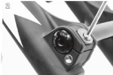
2. Apriete la sujeción de seguridad con una llave Allen de 4mm a 7Nm.
