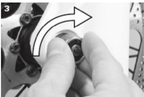
3. Abra la palanca completamente. Gire la tuerca en sentido horario hasta que la araña de expansión permanezca acoplada.
